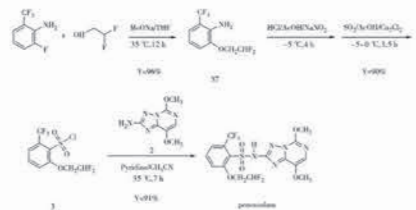
图13 以2-氟-6-三氟甲基苯胺为原料合成中间体(3)合成五氟磺草胺的路线
